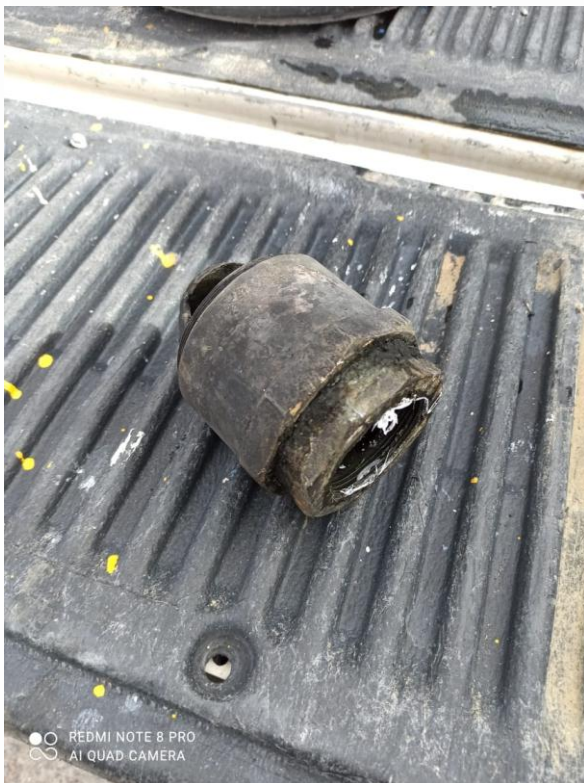
Reparación válvula de retención del aljibe
